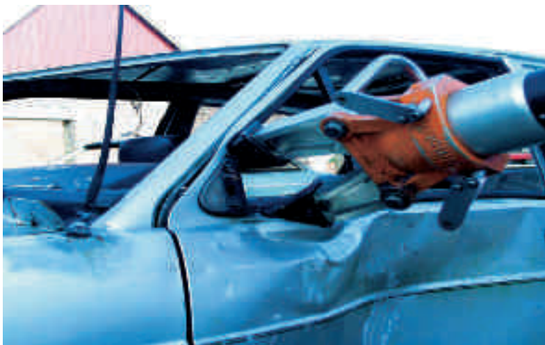
Sprederen mellem A-stolpe og dør
