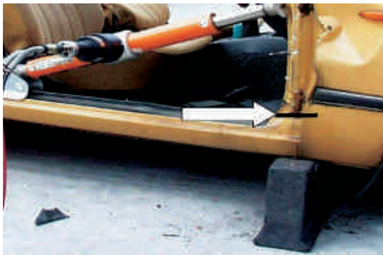
Klip i A-stolpen nederst - hjørneforstærker og ram placeret
