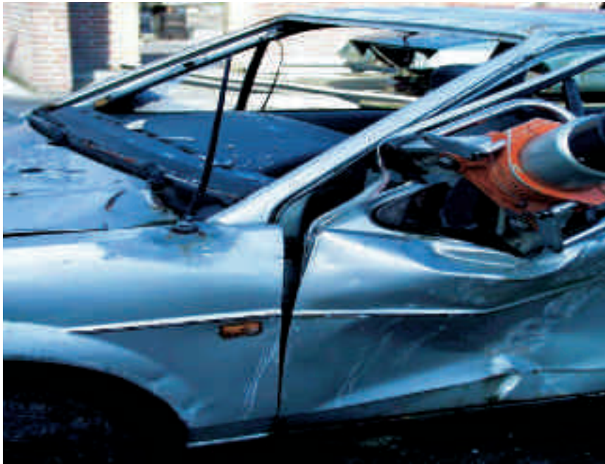
Spredning så hængslerne bliver synlige
