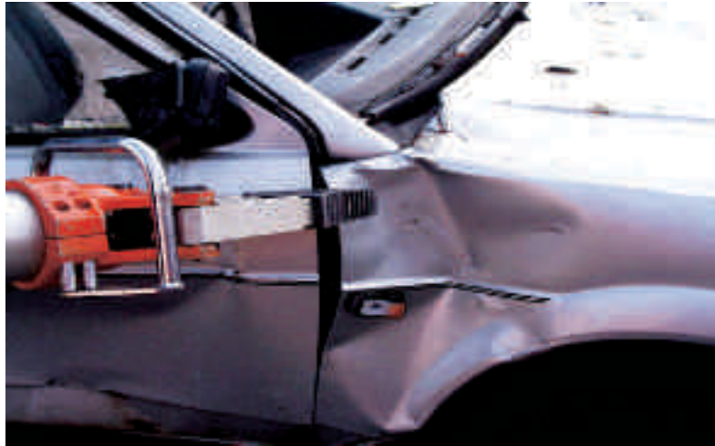
Sprederen klemmer om forskærm
