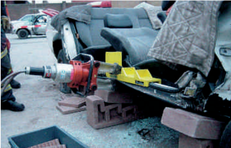
Spreaderen klemmes fast om hjørneforstærkeren
