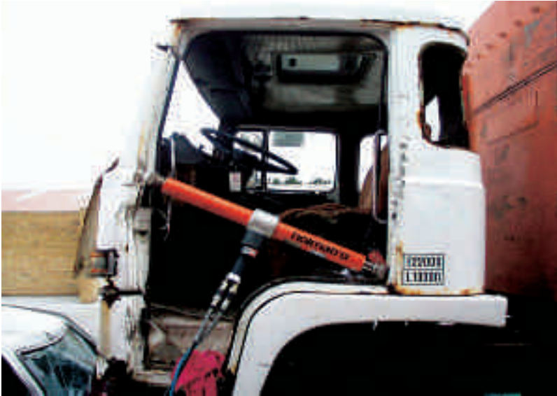
Ram placeret mellem A- og B-stolpe
