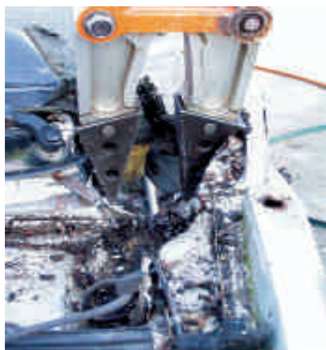
Sprederen i det store Y udvider langsomt
