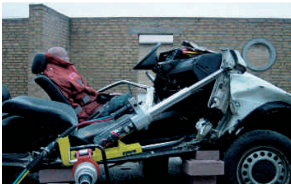
Ram placeret med anlæg mod hjørneforstærker eller spreders kæbe
