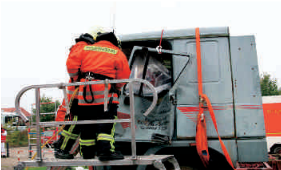
Fjernelse af dør fastholdt af reb
