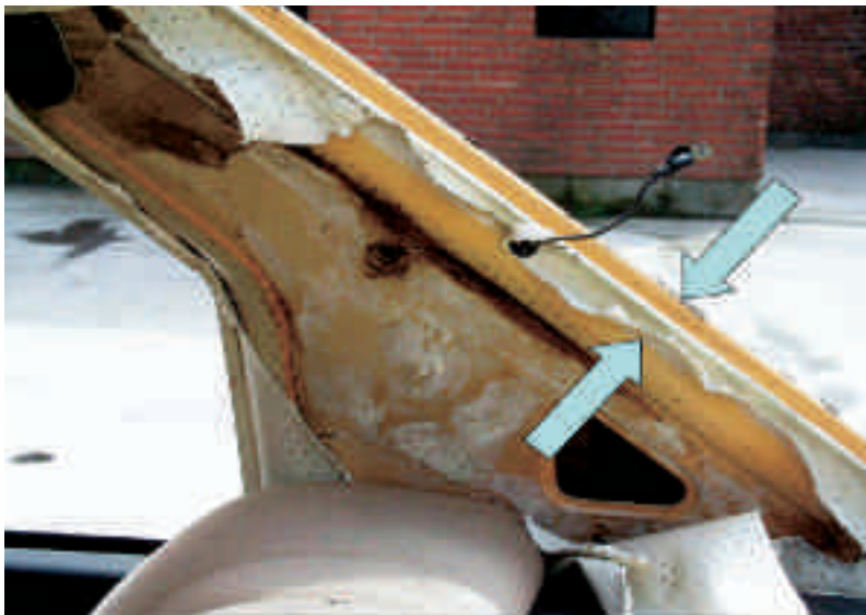
To-tre cm metal er hængsel i C-stolpen
