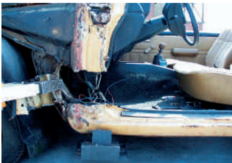
Sprederen åbner inspektionshul
