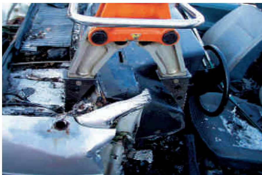
Sprederen klemmer over instrumentbord og torpedo
