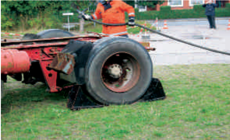
Sikringsslange klargøres – kiler ved hjulene
