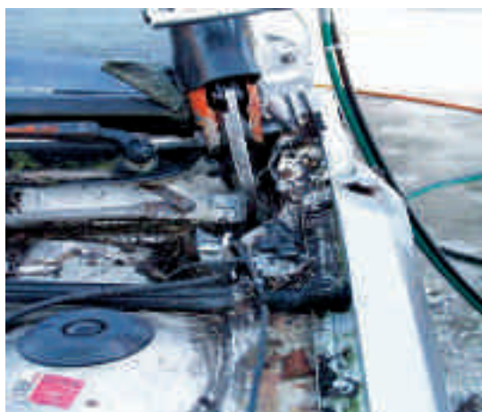
Saksen klipper et stort Y i torpedoen
