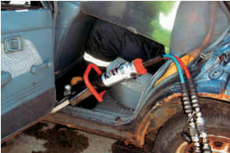
Klip i B-stolpen under nederste hængsel
