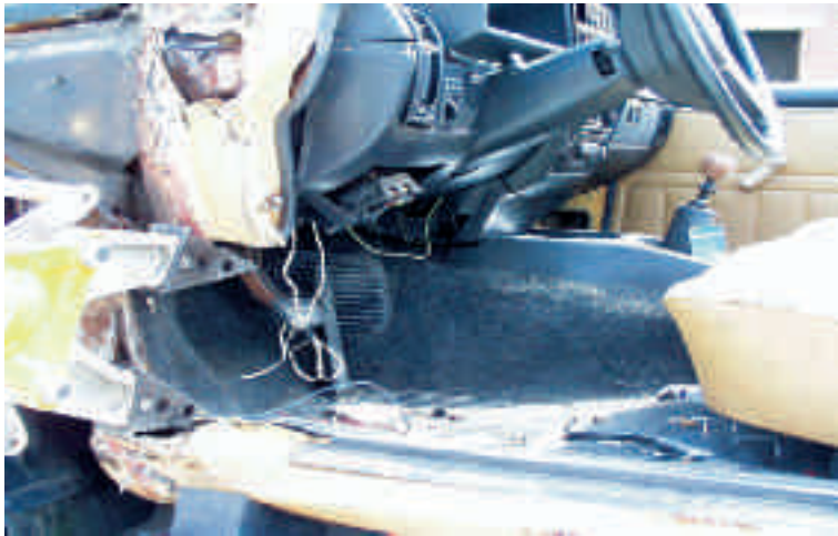
Sprederen løfter A-stolpe og instrumentbord
