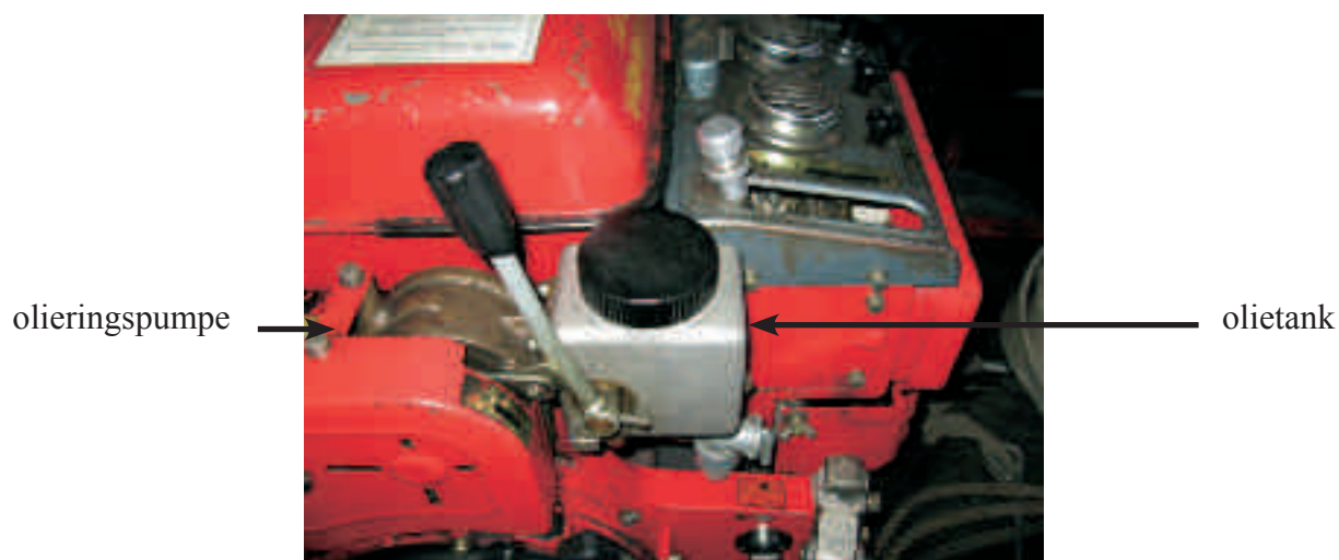
En Rabbit pumpe med olieringsansugning
