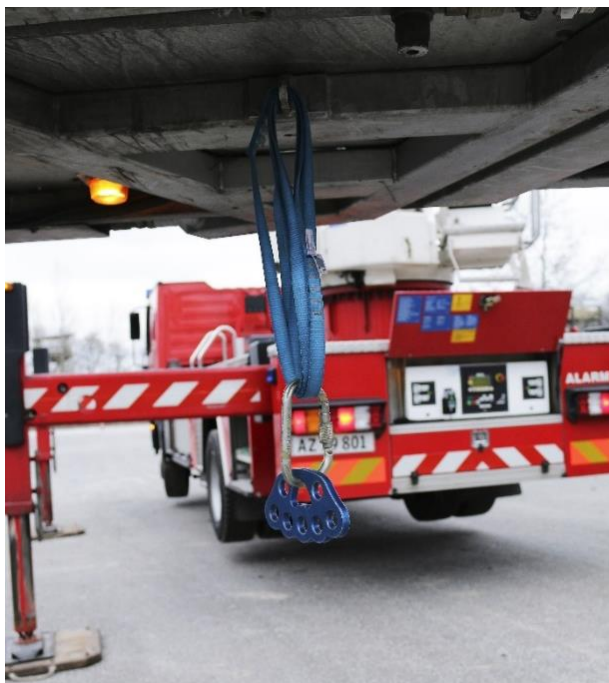
Ankerpunkt i redningslift
