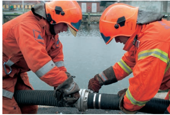
Sammenkobling af to sugeslanger
