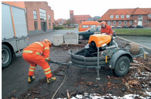
Forenden lidt under vandret mens bageste støtteben spændes
