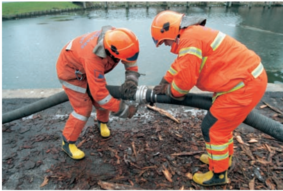
Sammenkobling af to sugeslanger
