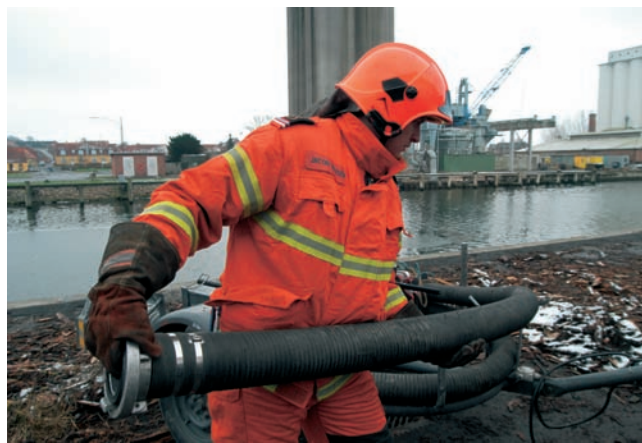
Motorpasserens fatning på sugeslangen
