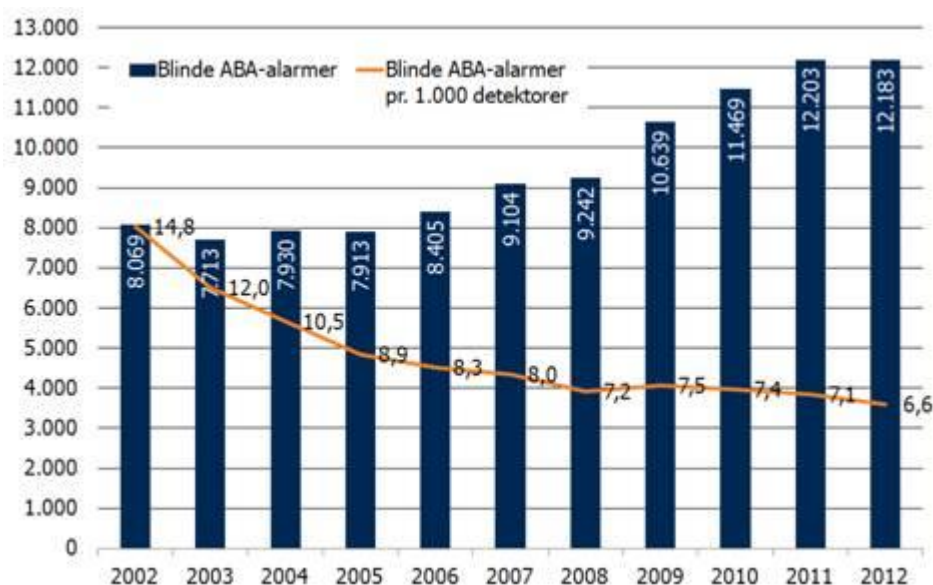
Figur 1: Blinde alarmer fra ABA-anlæg 1 og pr. 1.000 detektorer
